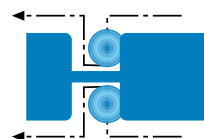
Verstellbare Eintauchtiefe der Seitenbürsten im Deichselbereich
