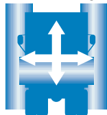
Dreibürstenwäsche mit konturenfolgender Dachbürste und mittenüberdeckenden Seitenbürsten
